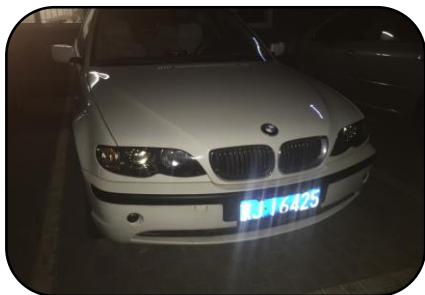
车牌区域反光，颜色偏白，边缘特征被弱化，但车牌区域与周围像素对比度高。
